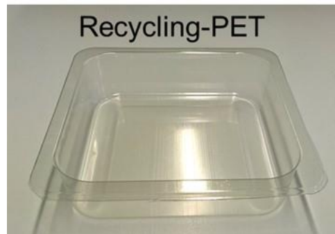
Abbildung 7-10: Am Fraunhofer IVV hergestellte Schalen aus Neuware- und Recycling-PET. Die aus 100 % Rezyklat bestehende Schale ist weniger transparent und hat eine gelbliche Verfärbung
